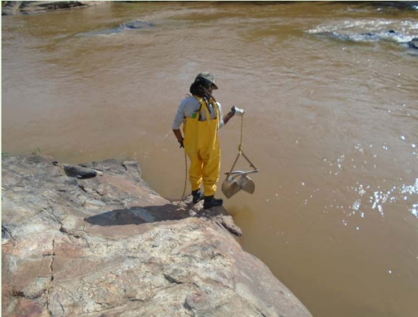
Figura 5.2-9: Coleta de sedimentos.
