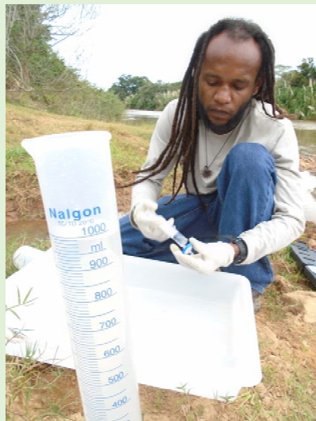
Figura 5.2-22: Coleta de clorofila através de filtro.
