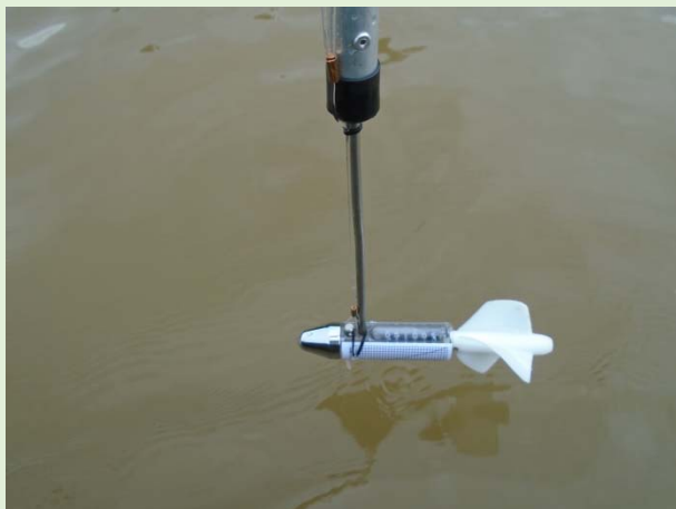
Figura 5.2-21: Aferição de velocidade da água.
