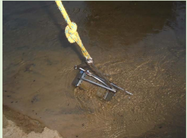
Figura 5.2-20: Coleta de sedimentos.
