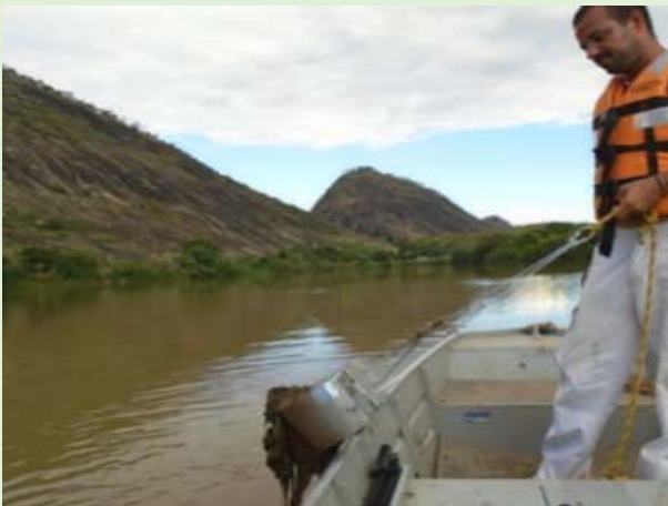
Figura 5.1-66: Coleta de sedimentos com a draga
