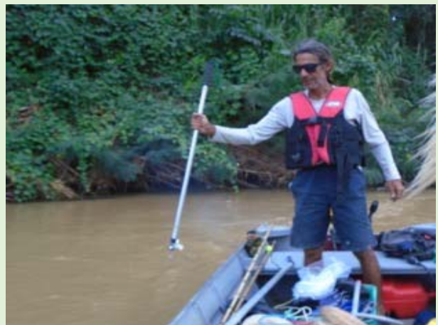
Figura 5.1-90: Coleta de dados de corrente com o fluxômetro
