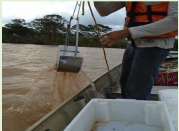
Figura 5.1-8: Coleta de sedimentos com a draga
