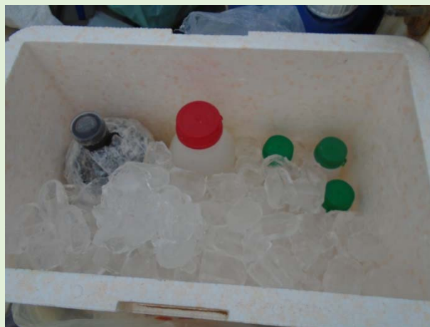
Figura 5.2-24: Acondicionamento das amostras de água.
