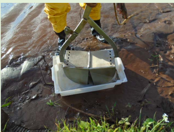
Figura 5.3-77: Ponto A01: Coleta bentos e sedimento
