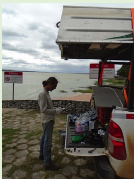
Figura 5.1-31: Aferição do multiparâmetro para análise e coleta da água
